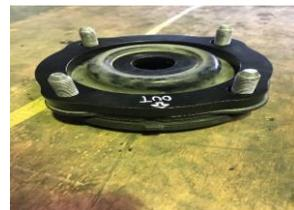
**Drivers Side (D/S) Strut Top Spacer P/N KDSS200-Spacer.**
